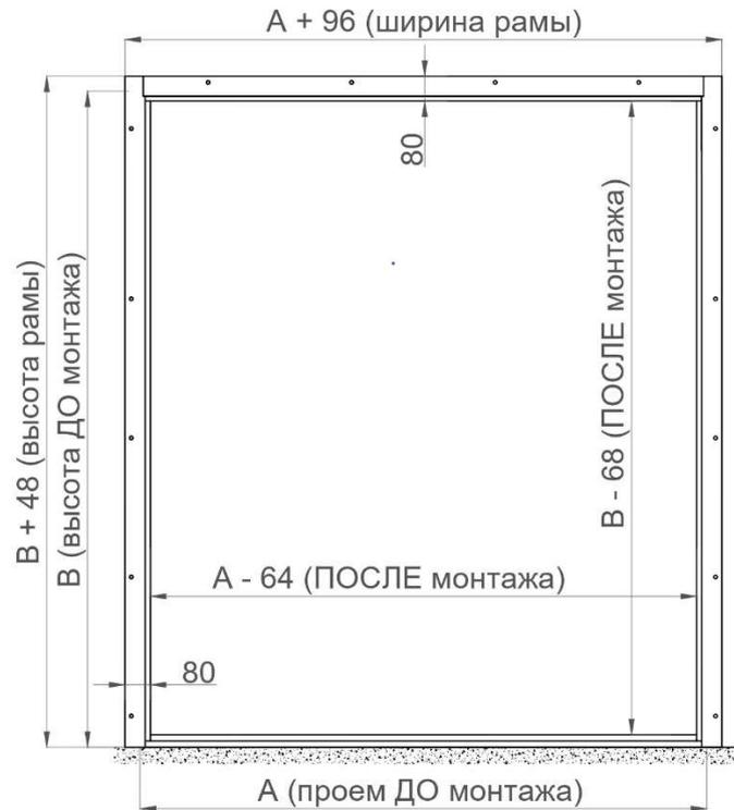
Рисунок 16. Металлическая рама в обхват проема, с порогом 40
