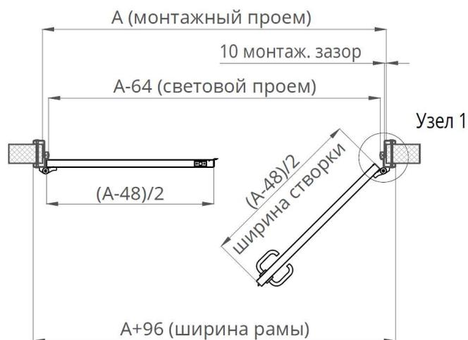
Рисунок 21. Разрез 1-1. Крепление рамы ТДД в обхват проема
