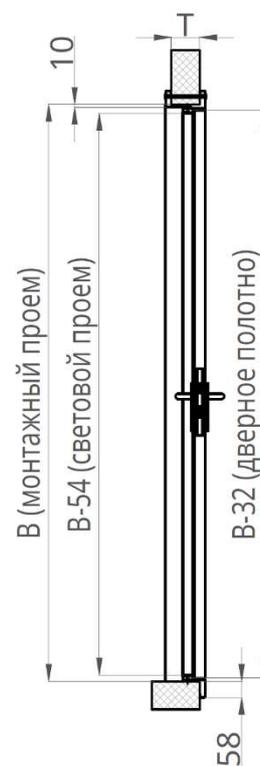
Рисунок 24. Разрез 4-4. Крепление рамы в обхват с порогом 60
