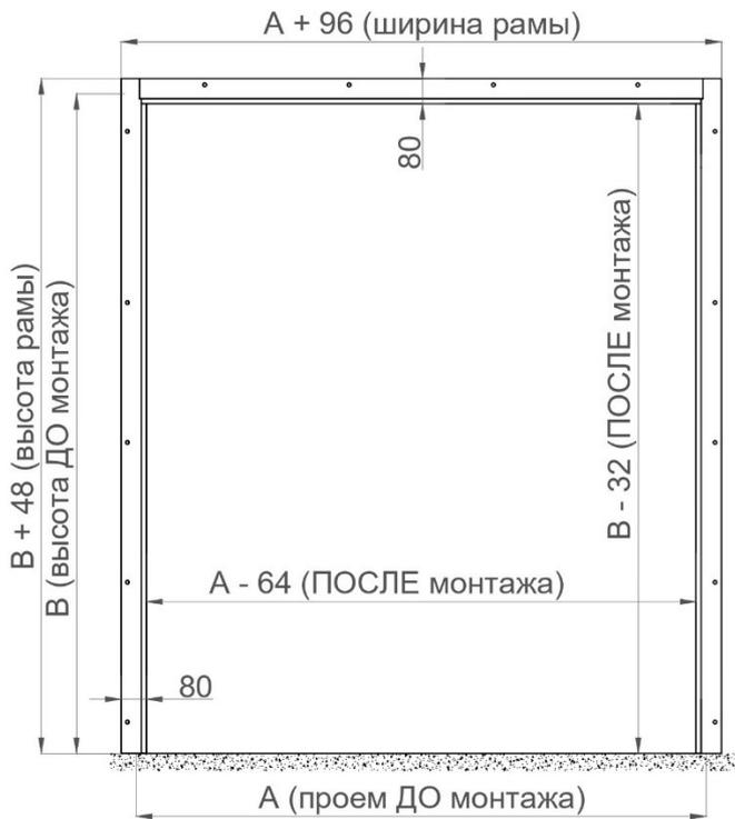
Рисунок 15. Металлическая рама в обхват проема, без порога
