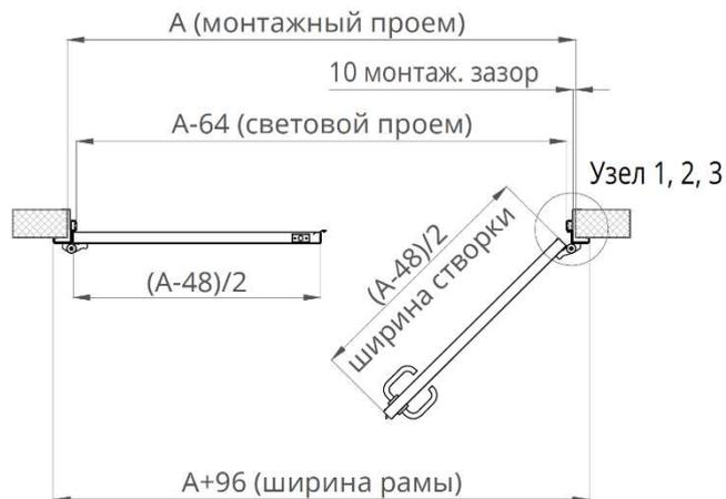
Рисунок 8. Разрез 1-1. Крепление угловой рамы ТДД
