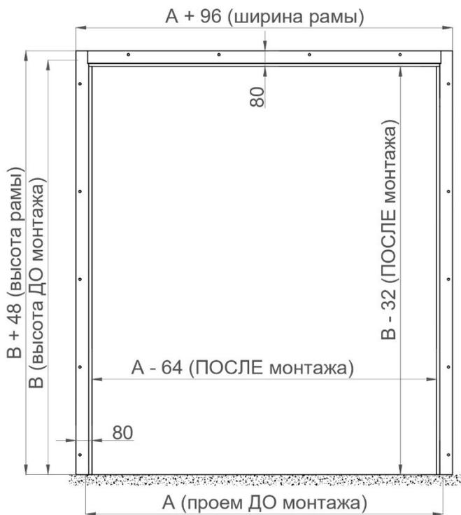
Рисунок 2. Металлическая угловая рама без порога
