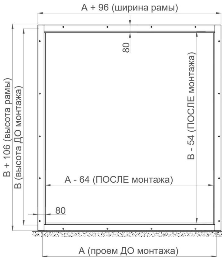
Рисунок 17. Металлическая рама в обхват проема, с порогом 60
